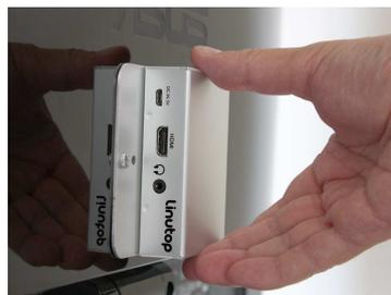
Le Linutop XS peut être accroché au dos du moniteur grâce à une fixation en option.
